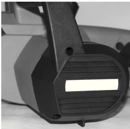
Грязные ребра воздухопроводов двигателя могут стать причиной его перегрева и поломки. Регулярно очищайте от загрязнений ребра воздухопроводов кисточкой и/или сжатым воздухом.
