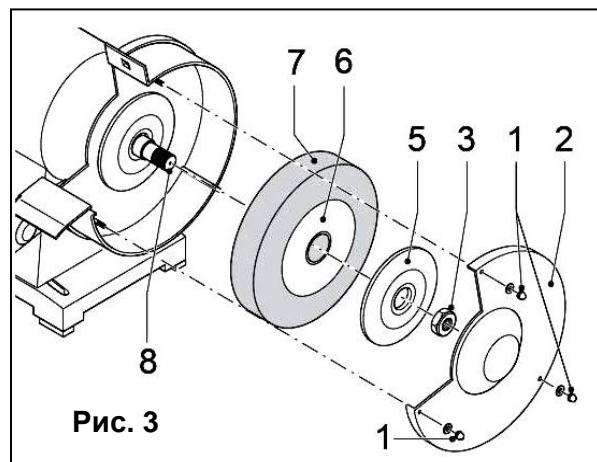
**⚠ Внимание!** Допускается использование дисков с различной зернистостью с максимально допустимой частотой оборотов больше 3000 об/мин.
