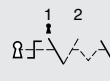
Переключатель на 2 положения с фиксацией, извлечение ключа в левом положении, НО контакт
