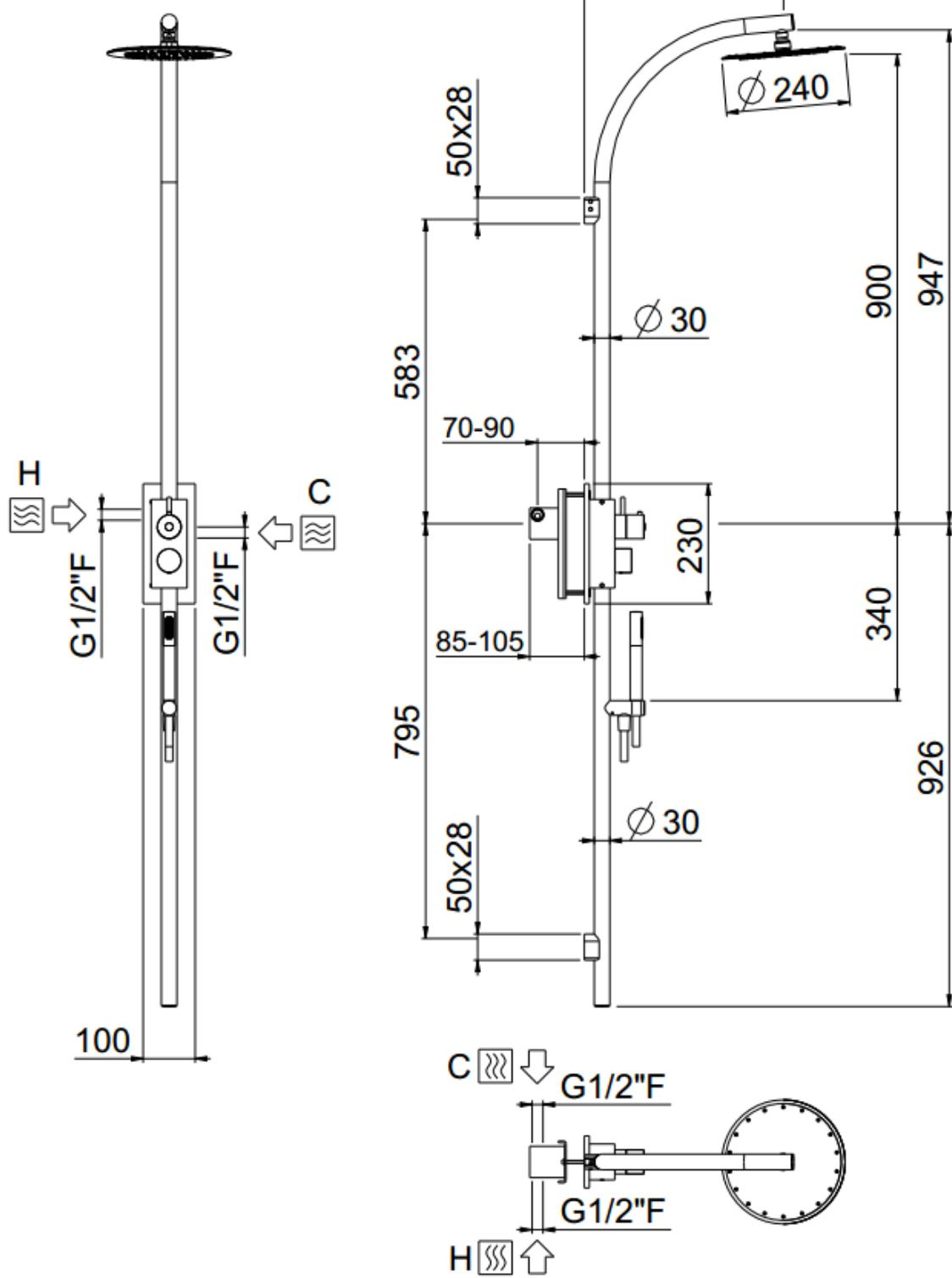
Preparare un foro adeguato nella parete ed inserirvi il gruppo incasso con la protezione MONTATA. Le quote d'installazione sono riportate in figura (la profondità d'incasso ammisible è intesa a parete finita compreso il rivestimento). Collegare il gruppo incasso all'impianto.
