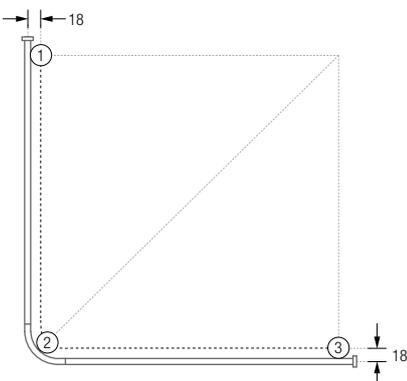
Die Bohrlöcher für die Deckenabhängungen befinden sich auf der Achslinie der Sackbohrungen jeweils 18 mm von der Innenkante der Duschvorhangstange nach innen versetzt.
