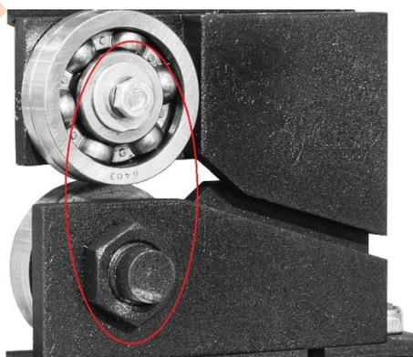
Рис 3. Регулировка ножей
