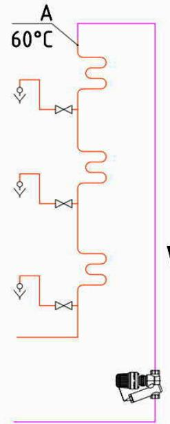
*В контрольной точке А должна поддерживаться температура 60°C. При расчетном циркуляционном расходе остывание воды на участке от точки А до клапана составляет 5°C. Клапан должен быть настроен на температуру 60-5=55°C.*
