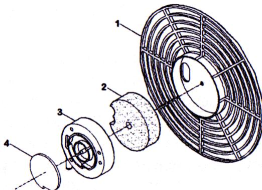
Воздушные фильтры следует регулярно проверять и чистить. В первую очередь фильтр забора воздуха (2), особенно если аппарат работает в пыльных помещениях. Для очистки нужно снять решетку (1), вынуть фильтр из гнезда (3), вымыть его со слабым моющим средством и высушить его перед тем, как установить вновь. Каждые 12 месяцев следует менять фильтр подачи воздуха (4).
