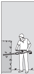
Обрезка сбоку: Телескопическая труба задвинута
