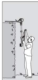
Высокая горизонтальная обрезка: Блок мотора наклонен на 75°, телескопическая труба удлинена
