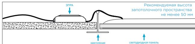
Подключение панели к сети 230 В производится через источник питания светодиодной панели ЭПРА:
