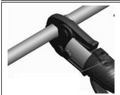
6.8. Нажмите кнопку пуска и выполните соединения. В случае ошибки, нажмите кнопку ручного возврата и вручную верните поршень в исходное положение
