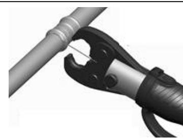
6.9. По окончании цикла опрессовки, поршень автоматически вернётся в исходное положение. Снимите пресс-насадку с фитинга
