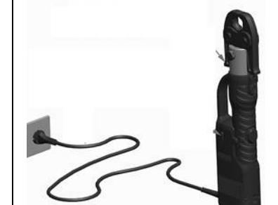
6.4. Нажмите и поверните стопорный палец 2 , при этом за счет пружины он выдвинется. Вставьте пресс-насадку, нажмите и поверните стопорный палец.
