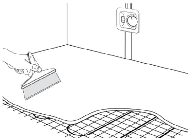
При нанесении и отверждении плиточного клея температура основания и окружающего воздуха должна быть от +5°C до +25°C. В помещении, где будут производиться работы, не должно быть сквозняков.
