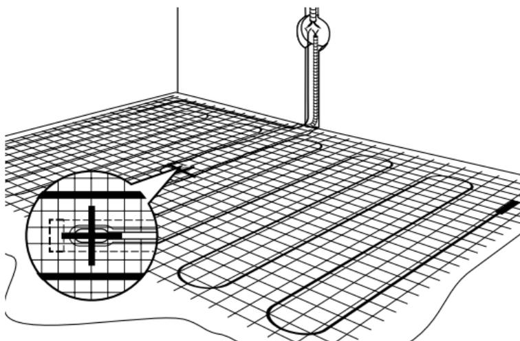
\* *Распаечная коробка используется в случае подключения к одному терморегулятору 2-х матов. Не входит в комплект поставки.*
