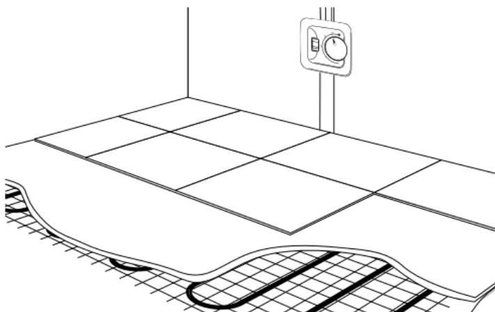
5.10. Измерьте сопротивление мата и датчика, и зафиксируйте на плане помещения (п. 9.2)
