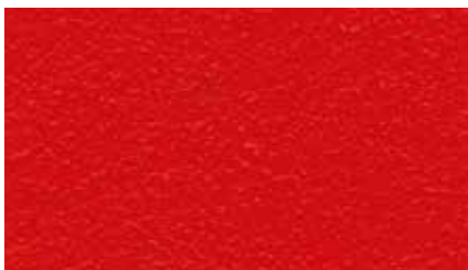
3020 rosso traffico con spargimento di sabbia quarzosa
