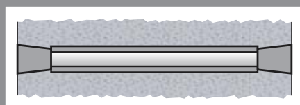
chiusura impermeabile e insonorizzata per aperture coniche un cono di chiusura in fibrocemento 5 cm.
