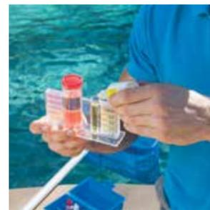
Se l'impianto non contiene un dispositivo per il controllo RedOx che regola il livello di cloro, è necessario controllarlo manualmente utilizzando uno strumento apposito. Anche se la sua piscina è attrezzata con un controllo automatico RedOx, occorre verificare il cloro manualmente in modo molto regolare (tutti i giorni). Questo impedirà all'impianto di generare più cloro del necessario che potrebbe sbiancare il rivestimento della piscina e irritare gli occhi.
