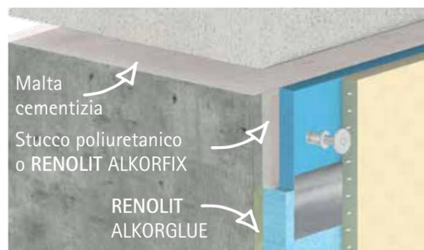
Nel caso delle ristrutturazioni, per non dover smontare il bordo in pietra, utilizzeremo il profilo colaminato standard. Il profilo plastificato si adatta perfettamente a qualsiasi forma delle pareti della piscina.
