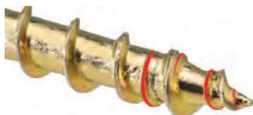
Punta brevettata con doppio filetto. I due filetti partono contemporaneamente dall'inizio della punta. Si riduce lo sforzo di avvitamento aumentando i valori d'estrazione. La vite non necessita di preforo e non danneggia le fibre, quindi ideale anche per l'utilizzo vicino ai bordi.
