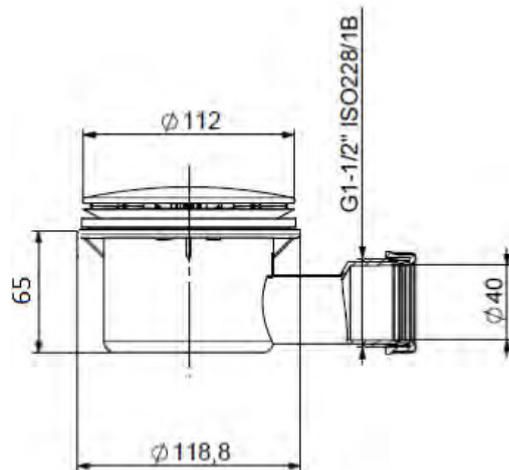
Misure in millimetri
