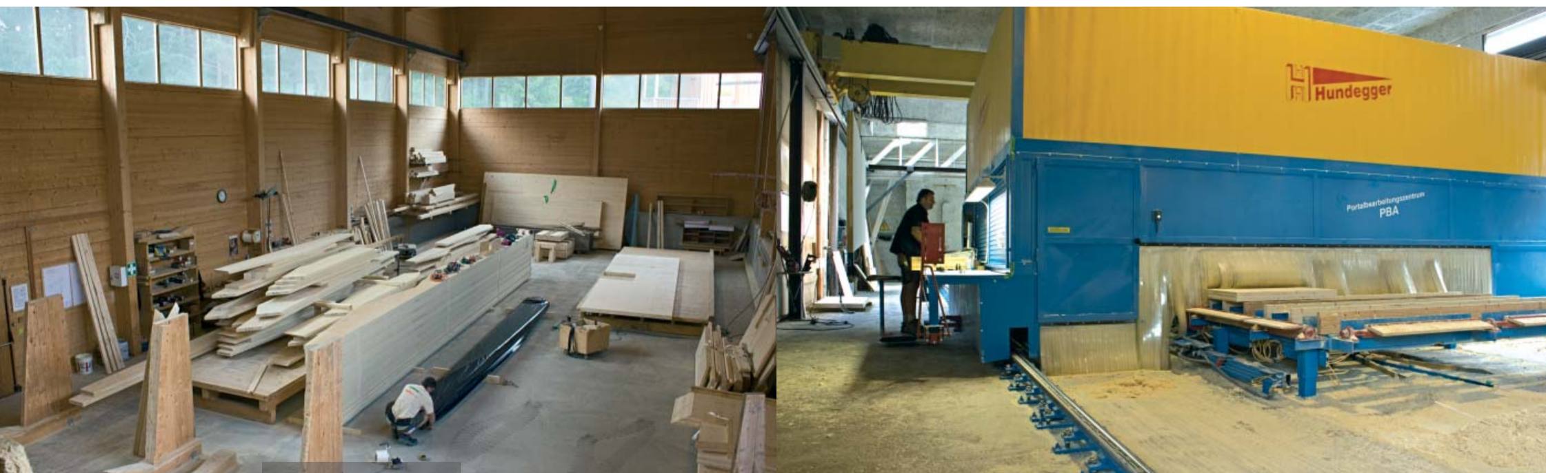
PRODUZIONE Il reparto di preassemblaggio e il centro taglio di Nova Ponente.
