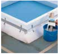
2 Teilmenge mit entsprechender Katalysatorzugabe sorgfältig mischen.
