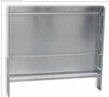
Armadietto Slim costruito in lamiera zincata, spessore 0,8 mm, piedini regolabili, altezza cm 72:78, dotato di rete metallica sullo schienale, falsi fori per entrate laterali, guide per coppia staffe disassate, coperchio di protezione per intonaci.
