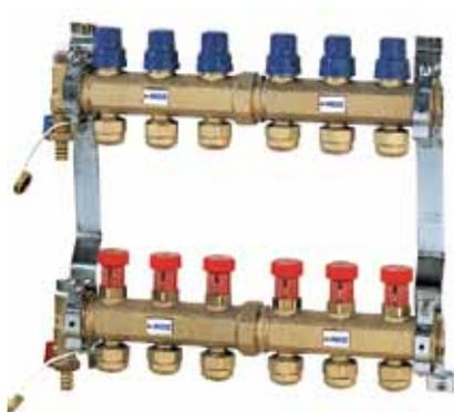
Collettori serie Control Ø 1 1/4" in ottone per la distribuzione dei tubi nei locali, completi di valvole di intercettazione (predisposte per la testina elettrotermica), detentori micrometrici con individuazione dei locali, gruppi di sfiato e scarico impianto a sfera con portagomma e tappi, staffe disassate con gommini antivibranti per inserimento in armadietto o fissaggio a muro, raccordi per il tubo in polietilene 14-10, 17-13 o 20-16.
