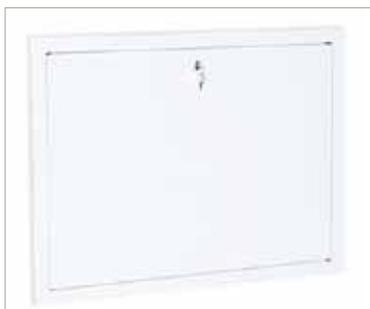
Telaio e porta metallica bianca verniciata a polveri con serratura per armadietto Slim. Spessore esterno 10,5 mm. Nella fornitura sono comprese 4 viti per il fissaggio al corpo armadietto.
