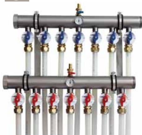
Collettori in acciaio inox Ø 2" per la distribuzione delle tubazioni Ø 25 mm nei capannoni industriali; completi di valvole a sfera di intercettazione e di regolazione, rubinetto di sfiato e carico impianto, termometri 0-60 °C su andata e ritorno, raccordi per tubo Ø 25 mm.
