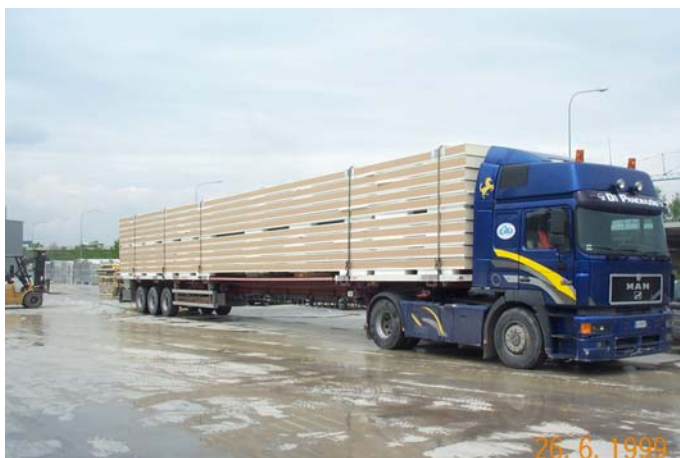
Pannello Jumbo Spessore 200 mm lunghezza 20.470 mm
