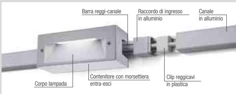
Il Sistema Portacavi con canale antivandalo, completamente in alluminio, consente di alimentare numerosi corpi lampada con il contenitore sporgente o wall washer con un unico punto luce.
