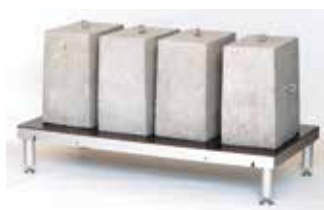
Modulo 100 x 200 cm Prova di carico 1720 kg
