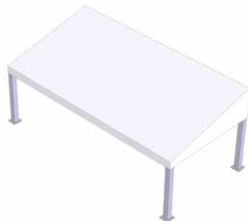
Tetto a uno spiovente con chiusure triangolari lati corti
