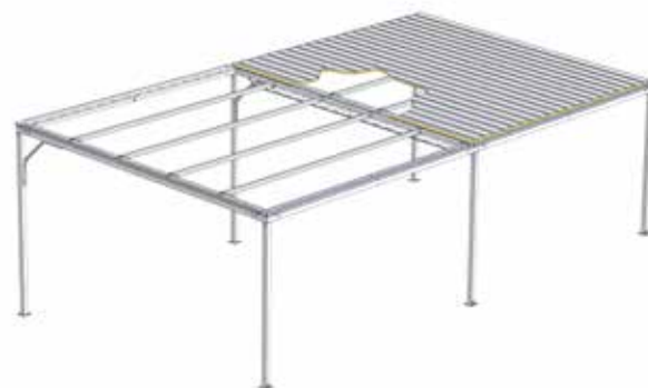
Tetto a uno spiovente inclinazione 5° pendenza 9% con trave centrale rinforzata ideale per coperture rigida. Es. dim. 5x10 m
