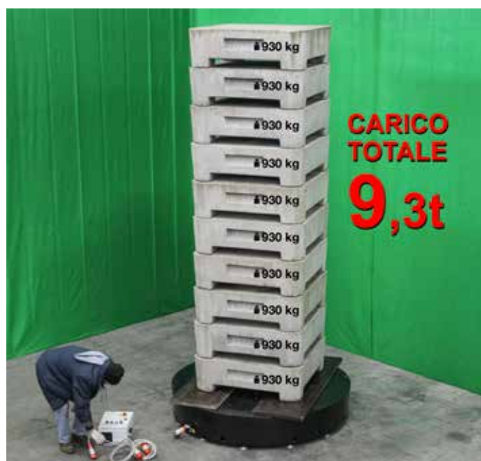
Piattaforma rotante Caravaggio Ø 1,95 m - altezza 45 cm - carico 9,3t
