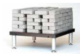
Modulo 100 x 100 cm Prova di carico 600 kg
