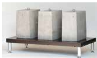
Modulo 100 x 200 cm Prova di carico 1290 kg
