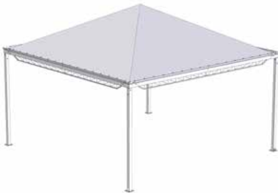
Tetto a piramide con canali rinforzati per aumentare i carichi accidentali
