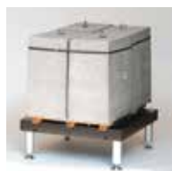
Modulo 100 x 100 cm Prova di carico 1720 kg
