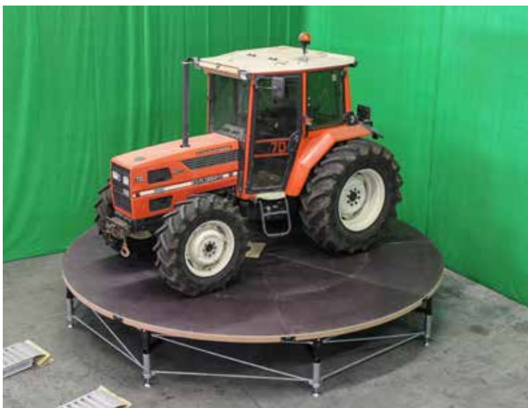
Ø 4,95 m - altezza / height 80 cm - carico / load 3,6t
