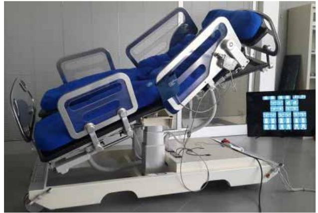
Il dispositivo ARAMIS è un sistema robo-meccatronico per la riabilitazione motoria ed il recupero funzionale dell'arto superiore di pazienti con esiti di Gravi Cerebrolesioni.
