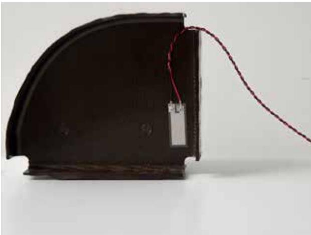
Il monitoraggio tramite sensori piezoelettrici è effettuato su strutture/componenti industriali. I sensori a film sottile di materiale piezoelettrico utilizzati consentono di monitorare lo stato deformativo delle strutture su cui vengono posizionati, con una risoluzione dell'ordine del micro metro. Accelerometri piezoelettrici consentono il monitoraggio delle vibrazioni.
