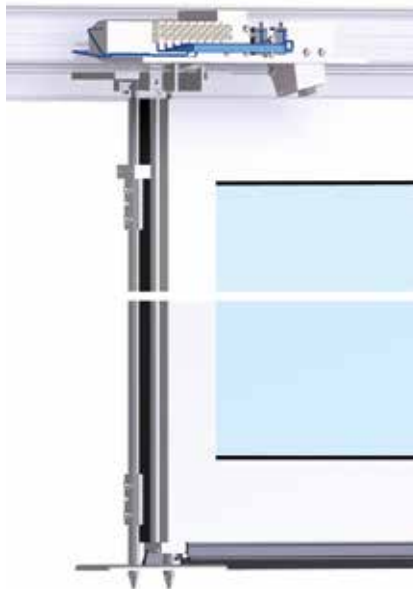
Sistema di bloccaggio a barra
