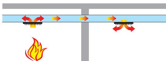
Il fuoco può propagarsi per convezione attraverso le aperture della condotta nel compartimento in cui è presente l'incendio.
