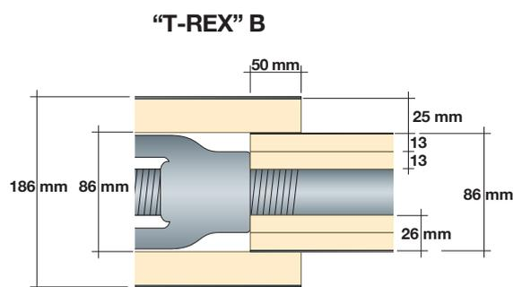
**Applicazione:** aprire leggermente il guscio metallico con il materiale isolante e inserire il tirante, stringere il guscio metallico ed avvitare le viti auto perforanti a passo 170 mm sui fori predisposti per fare scorrere la coppella da un lato.
