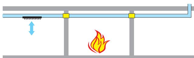
uso di serrande tagliafuoco che isolano automaticamente il compartimento interessato.
