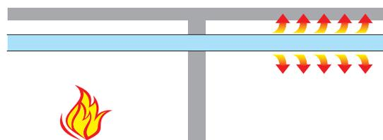
Le pareti della condotta in acciaio, riscaldandosi rapidamente, trasmettono l'incendio ai compartimenti vicini per irraggiamento.
