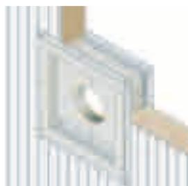
Fissare con viti autofilettanti profilo a "L" sia sopra che sotto, in maniera che la prima lastra di FIREGUARD® 45 risulti centrale rispetto allo spessore del foro (135 mm).
