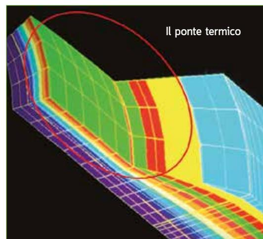
Simulazione termografica di una sezione di tubazione con fluido di raffreddamento a 7°C, isolata solo parzialmente, con relativo andamento delle temperature.
