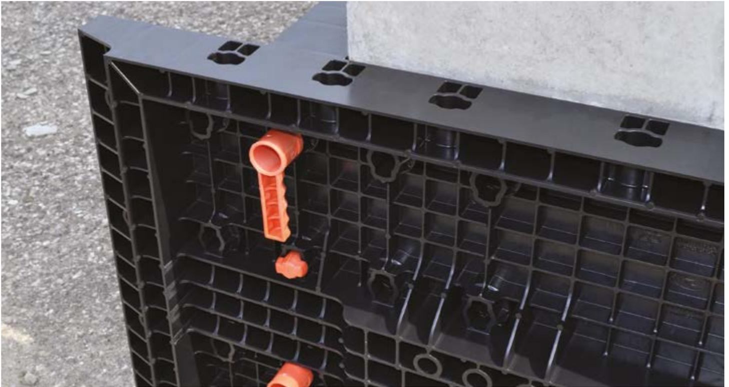
GEOPANEL STAR è un sistema di cassetteria regolabile per pilastri in calcestruzzo quadrati e rettangolari. Realizzato in ABS, è una nuova concezione di cassero: leggero e modulare, di semplice manutenzione, può essere agevolmente movimentato, trasportato e stoccato per successivi riutilizzi.
