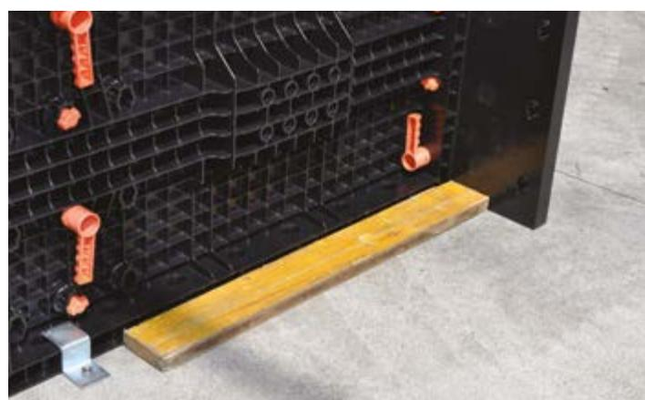
Il fissaggio a terra può essere effettuato utilizzando dei listelli in legno, delle staffe o dei tiranti. Questo metodo di fissaggio permette di annullare l'eventuale sollevamento dei pannelli.
