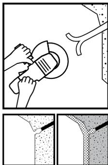
**PULIZIA E PROTEZIONE DEI "FERRI" DI ARMATURA:** si dovranno riportare alla luce tutte le parti dell'armatura che dovessero risultare corrose e deteriorate dalla ruggine di ossidazione e si puliranno fino al grado consigliato di derugginazione Sa secondo DIN 55 928; si proteggeranno adeguatamente i "ferri" di armatura puliti; infine, se i ferri dovessero essere troppo superficiali sarà necessario "fresarli" con
