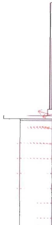
Fig. 11 – Linee di flusso nel ponte termico bancale in pietra serena (spessore 3 cm).
