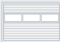
Motivo 480 Riempimento a elementi con telaio in alluminio riempito con griglia stirata Sezione trasversale di aerazione: 58% della superficie di riempimento per telaio
